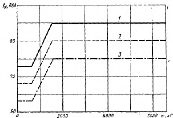
График зависимости максимально допустимых уровней шума от максимальной взлетной массы для винтовых самолетов легкой весовой категории
