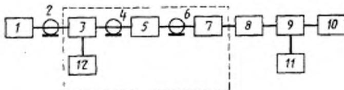
1—измерительный генератор; 2, 4, 6—коаксиальный кабель; 3—коаксиальный переключатель; 5—фильтр; 7—согласующее устройство; 8—коаксиальный соединитель; 9—коаксиальный измерительный соединитель-тройник (например элемент № 11—1 из комплекта вольтметра типа ВЗ—24); 10—поверяемый вольтметр; 11—образцовый вольтметр; 12—нагрузочный резистор
