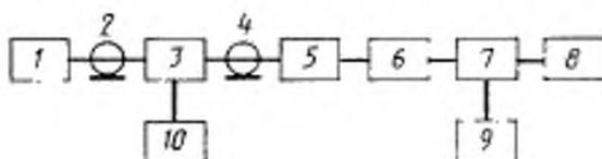
1—измерительный генератор; 2, 4—коаксиальный кабель; 3—коаксиальный переключатель; 5—фильтр; 6—коаксиальный соединитель; 7—коаксиальный измерительный соединитель-тройник (например элемент № 11 из комплекта вольтметра типа ВЗ—24); 8—поверяемый вольтметр; 9—образцовый вольтметр; 10—нагрузочный резистор
