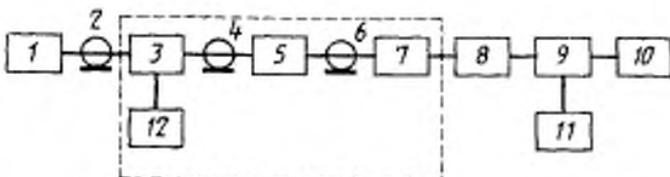
1—измерительный генератор; 2, 4, 6—коаксиальный кабель; 3—коаксиальный переключатель; 5—фильтр; 7—согласующее устройство; 8—коаксиальный соединитель; 9—образцовый делитель напряжения; 10—поверяемый вольтметр; 11—образцовый вольтметр; 12—нагрузочный резистор
