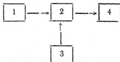
1—измеритель температуры (при приведении темнового тока к 20 °С); 2—светонепроницаемая камера с фотоумножителем; 3—источник питания фотоумножителя с делителем напряжения (или отдельные источники питания электродов) и вольтметром контроля режима; 4—амперметр
