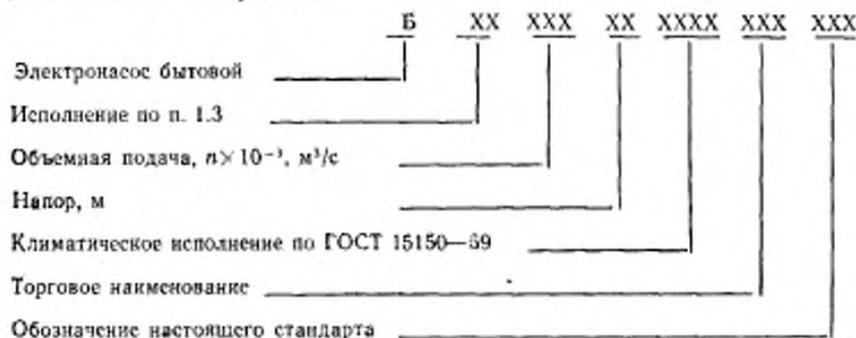
Пример условного обозначения вибрационного электронасоса с объемной подачей  $0,1 \cdot 10^{-3} м^3/с$ , напором 63 м, климатического исполнения У5 по ГОСТ 15150—69, торговым наименованием «Малыш—М».
