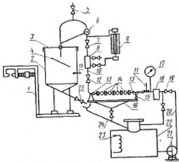
1—устройство для измерения массы; 2—таря; 3—крышка тары; 4—стурогаситель; 5—воздухоотводящий кран; 6—смотровое стекло; 7—насадочный кран; 8—смотровое стекло; 9—расходомер; 10, 20—подводящий трубопровод; 11—термометр; 12—регулирующий кран; 13—устройство для подсоединения счетчиков; 14—счетчики; 15, 25—сливной кран; 16—стол-стенка; 17—манометр; 18—фильтр-воздухоотделитель; 19—пусковой кран; 21—насос; 22—резервуар; 23—нагреватель или охладитель; 24—сливной трубопровод
