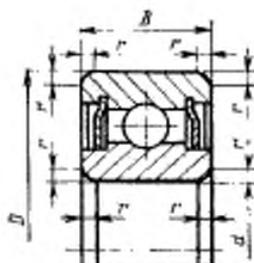
$d$ —номинальный диаметр отверстия внутреннего кольца;  $D$ —номинальный диаметр наружной цилиндрической поверхности наружного кольца;  $B$ —номинальная ширина подшипника;  $r$ —номинальная координата монтажной фаски.
