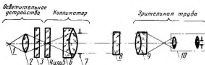
1—источник света; 2—конденсор; 3—сменный фильтр или матовое стекло; 4—набор штриховых миры; 5—набор точечных диафрагм (4, 5—сменные); 6—объектив коллиматора; 7—диафрагма коллиматора; 8—образец стекла; 9—объектив зрительной трубы; 10—микроскоп
