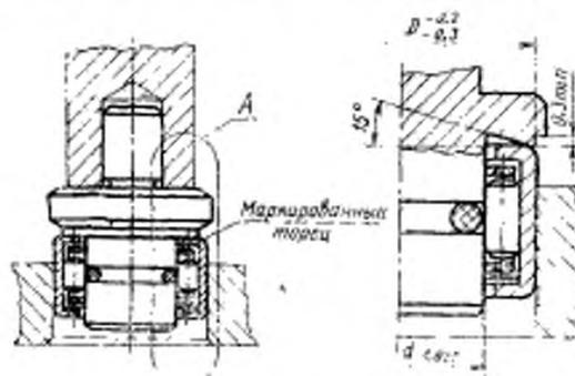
Подшипник устанавливают предварительно на оправку, на которой он удерживается упругим кольцом, и прикладывают усилие при монтаже к маркированному торцу подшипника
