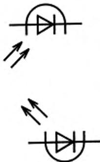
2. Взаимная ориентация обозначений источника и приемника не устанавливается, а определяется удобством вычерчивания схемы, например:
