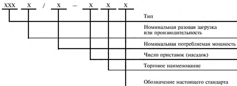
Пример условного обозначения электромясорубки бытовой куттерной с номинальной разовой нагрузкой 0,25 кг, номинальной потребляемой мощностью не более 1000 Вт, с двумя приставками, торговое наименование «Флора»:
