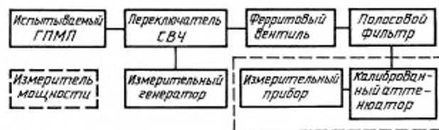
Рисунок В.1 — Структурная схема измерения относительного уровня побочных колебаний ГПМП методом замещения
