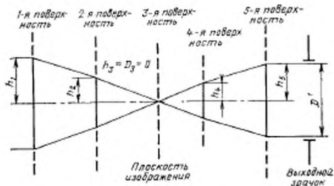
Диаметр рабочего отверстия  $n$ -й поверхности оптической системы  $D_n$  вычисляют по одной из следующих формул:
