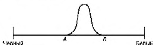
Рисунок В.1 — Определение динамического диапазона
