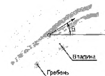
Рисунок 3 — Расположение и ориентация контрольной точки бифуркации гребня, определенной через точку бифуркации основы гребней
