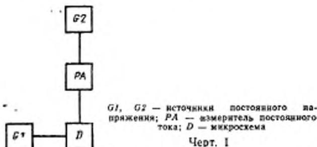
*G1, G2* — источники постоянного напряжения; *PA* — измеритель постоянного тока; *D* — микросхема
