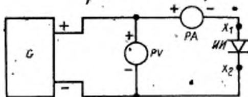
$G$  — источник постоянного (немодулированного или модулированного) напряжения;  $PV$  — измеритель напряжения;  $PA$  — измеритель тока;  $II$  — испытуемый индикатор;  $X_1$  и  $X_2$  — контакты подключения испытуемого индикатора
