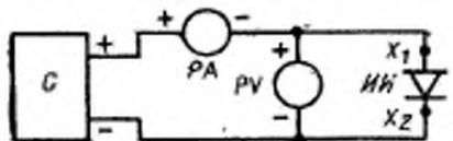
*G* — источник постоянного (немодулированного или модулированного) тока; *PA* — измеритель тока; *PV* — измеритель напряжения; *ИИ* — испытуемый индикатор; *X<sub>1</sub>* и *X<sub>2</sub>* — контакты подключения испытуемого индикатора.
