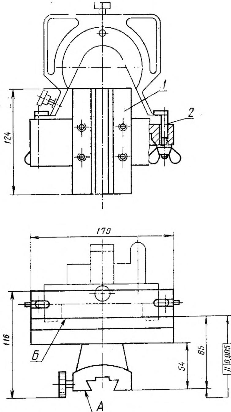
1 — кронштейн; 2 — винт; А и Б — базовые поверхности
