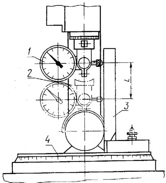
1 — индикатор; 2 — колонка микроскопа; 3 — угольник; 4 — предметное стекло
