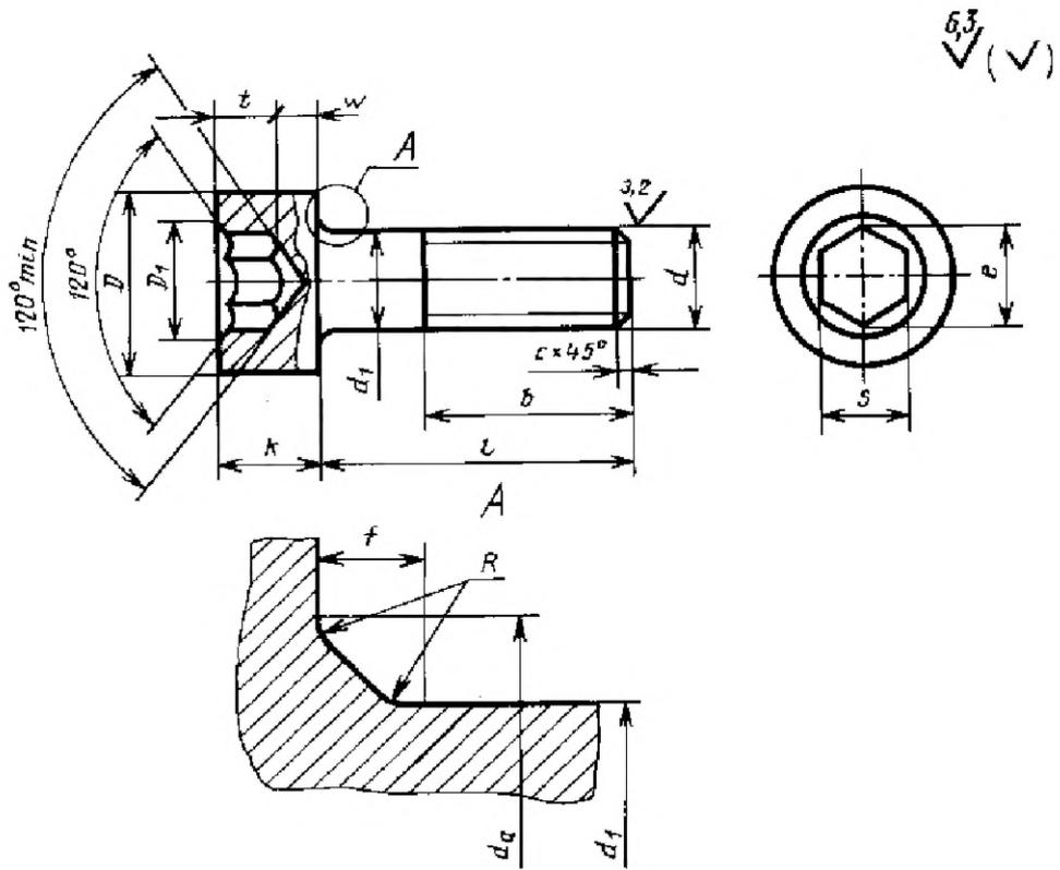
Вариант изготовления углубления
