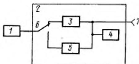
1—приемное устройство; 2—блок преобразования и регистрации; 3—канал измерения средней мощности (облученности) непрерывного излучения; 4—отсчетное устройство; 5—канал измерения энергии (энергетической экспозиции) импульсного и импульсно-модулированного излучения; 6—переключатель режимов измерения; 7—выход на внешний регистрирующий прибор
