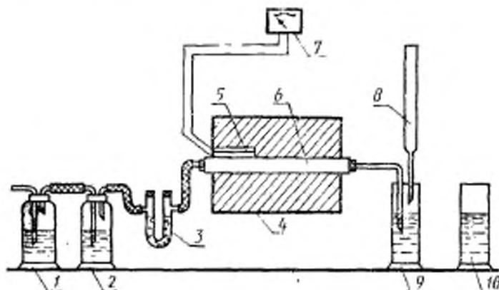
1—склянка с 30%-ным раствором щелочи; 2—склянка с концентрированной серной кислотой (плотностью—1,84 г/см<sup>3</sup>); 3—U-образная трубка с плавленным хлористым кальцием; 4—трубчатая печь; 5—термопара; 6—фарфоровая трубка; 7—милливольтметр; 8—бюретка; 9—поглотительная склянка; 10—контрольный сосуд
