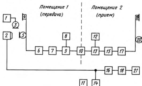
1, 11 — вольтметры; 2 — прибор «рот искусственный»; 3 — измерительный микрофон; 4, 17 — телефоны испытуемых телефонных аппаратов; 5, 18 — микрофоны испытуемых телефонных аппаратов; 6, 14 — источники постоянного напряжения; 7, 15 — испытуемые телефонные аппараты; 8, 12 — искусственные абонентские линии; 9 — искусственная соединительная линия; 10 — установка для создания шума; 13 — согласующее устройство; 16 — МЗ; 19 — генератор сигналов низкочастотный
