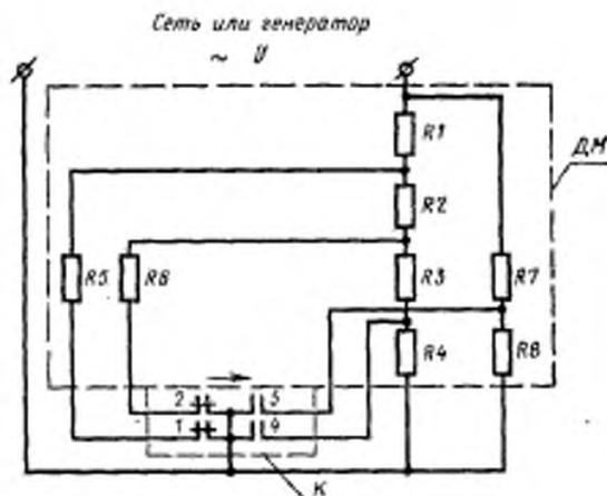
ДМ — делитель мощности на резисторах; К — контактор (переключатель нагрузки).
