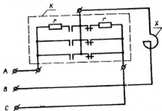
X — нагрузочный реактор; K — контактор (переключатель нагрузки) с токоограничивающими резисторами
