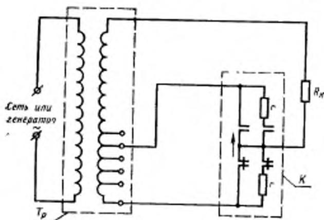
$R_H$  — нагрузочный резистор;  $T_D$  — испытательный трансформатор или автотрансформатор;  $K$  — контактор (переключатель нагрузки) с токоограничивающим резистором.
