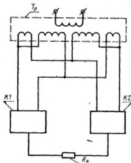
$T_p$  — испытательный трансформатор или автотрансформатор;  $K1$ ,  $K2$  — фазы контактора (переключателя нагрузки);  $R_n$  — нагрузочный резистор.
