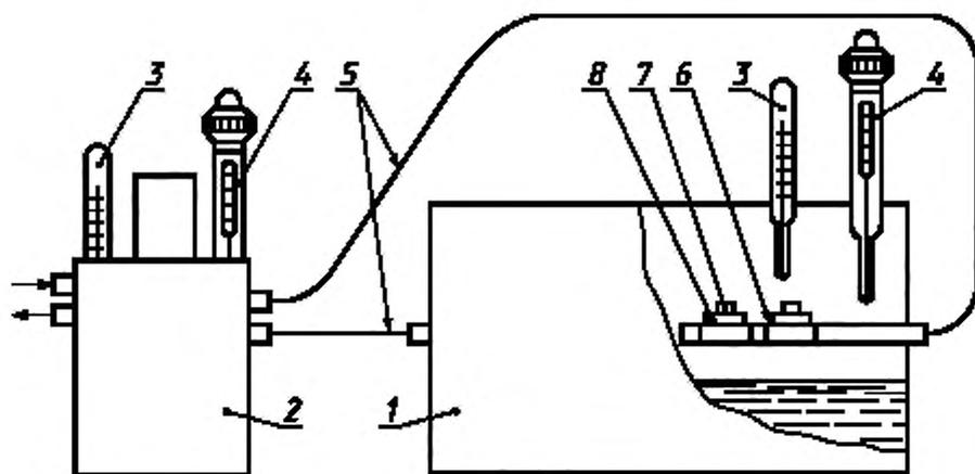
1 — камера влажности; 2 — ультратермостат; 3 — ртутные стеклянные лабораторные термометры; 4 — контактные термометры; 5 — резиновые шланги; 6 — стеклоячейка; 7 — медная пластинка; 8 — стальная пластинка
