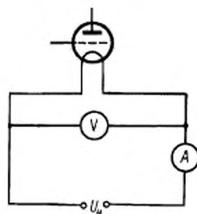
$U_n$  — источник постоянного напряжения накала;  $V$  — вольтметр постоянного тока;  $A$  — амперметр постоянного тока
