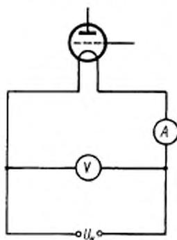
$U_n$  — источник постоянного напряжения накала;
