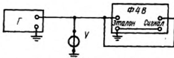
Г—измерительный генератор; V—образцовый вольтметр;
