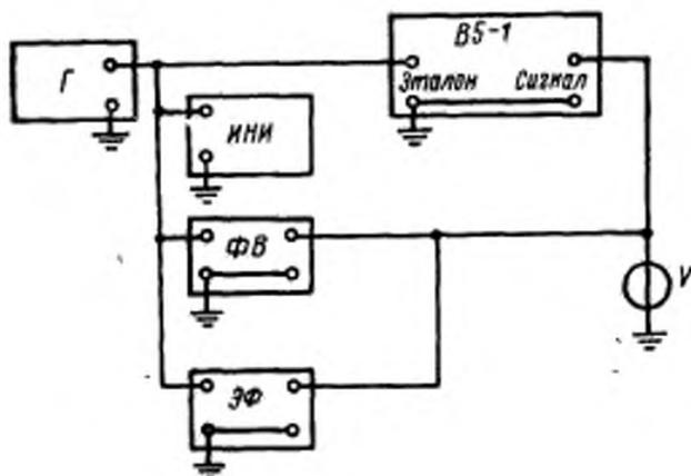
Схема проверки вольтметра В5—2
