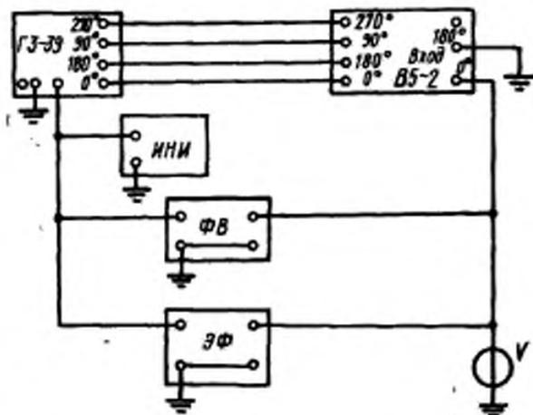
Г — измерительный генератор; ФВ — фазовращательное устройство; ЭФ — образцовый электронный фазометр; V — образцовый вольтметр; ИНИ — измеритель нелинейных искажений.
