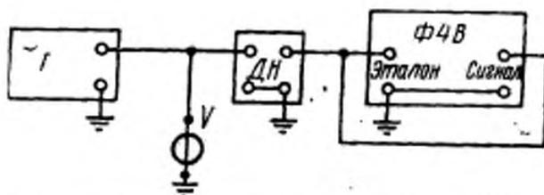
Г—измерительный генератор; V—образцовый вольтметр;
