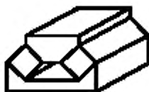
Пример 1 — Две ортогональные плоскости симметрии (10 различных ненулевых элементов)
