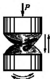
Рисунок 7 — Схема складкообразования элементарной пробы при испытании на установке типа ИМИ
