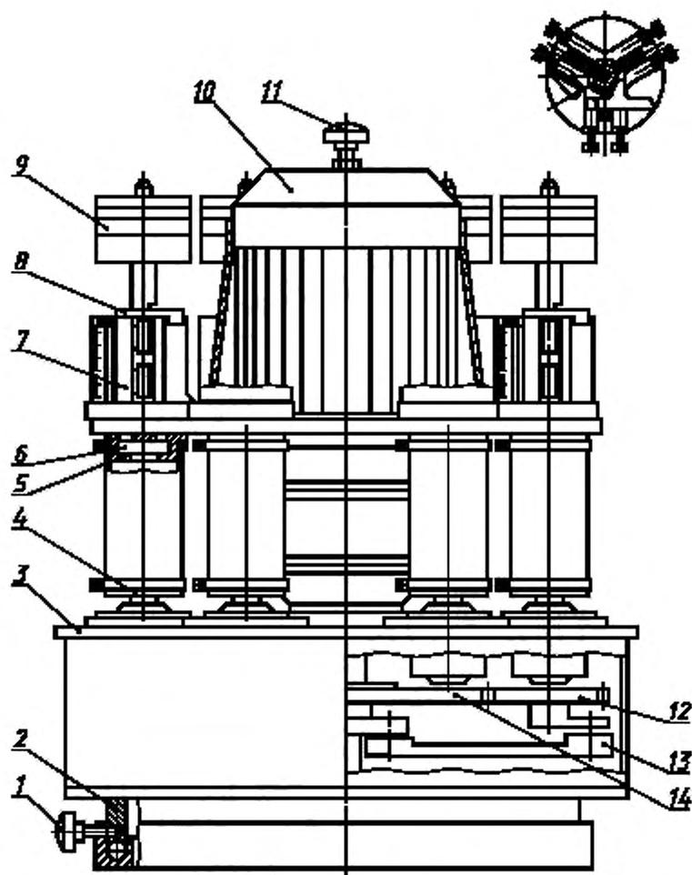
1 — стопорный винт; 2 — опора на шариках; 3 — основание; 4 — нижний зажим; 5 — верхний зажим;
