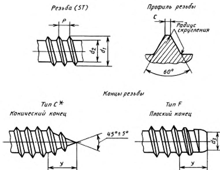
\* При накатке резьбы не допускается выход металла за вершину конуса. Необходимо скругление или притупление конца.
