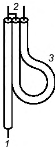
1 — несимметричный вход; 2 — симметричный выход; 3 — полуволновая петля
