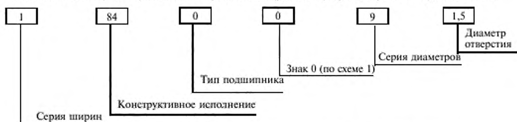
Подшипник 32205 — радиальный роликовый с короткими цилиндрическими роликами
