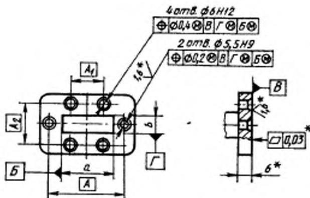
\* Размеры, допуск плоскостности и шероховатости поверхностей для справок.
