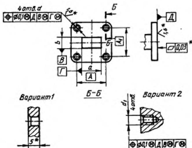
\* Размеры, допуск плоскостности и шероховатости поверхностей для справок.
