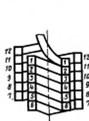
Двухслойная цилиндрическая обмотка трансформатора (к термину 7.2.5)
