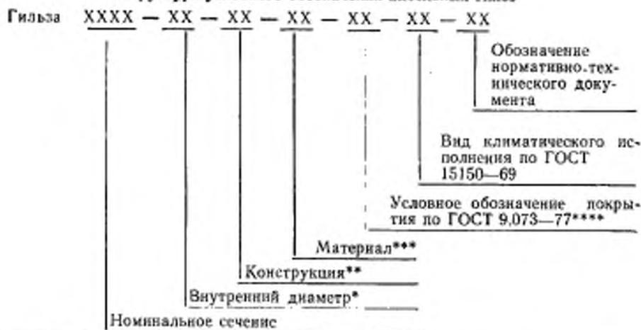
\* Для ответвительных гильз указывают внутренние диаметры для основного кабеля или провода и ответвляемого.
