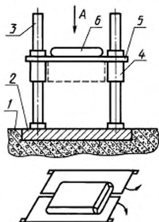
1 — фундамент; 2 — стальная плита; 3 — направляющая; 4 — подъемный механизм;
