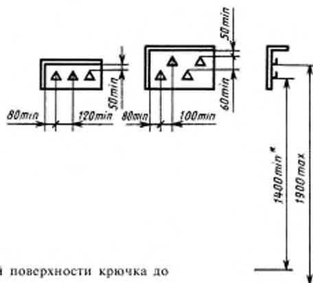
\* Расстояние от рабочей поверхности крючка до нижнего ограничивающего элемента.
