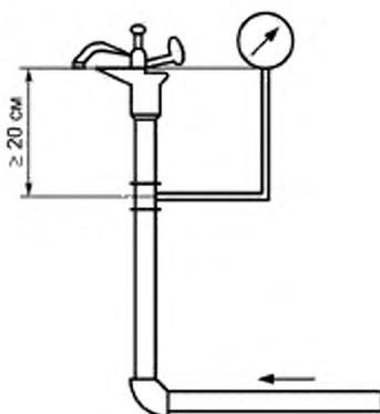
Рисунок 1 — Измерение давления в дождевальном аппарате
