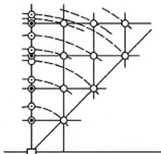
⊙ — расположение дождемеров вдоль радиуса; ⊕ — имитация расположения дождемеров, представляющих расположение дождемеров по полноповоротному методу. Количество воды в имитируемых дождемерах рассчитывают в зависимости от радиального расстояния от испытываемого спринклера; ○ — расположение дождемеров в соответствии с полноповоротным методом для вычисления коэффициента равномерности орошения с учетом перекрытия;
