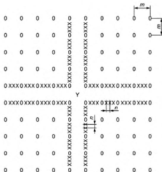
$m = 2$  м для дождевальных аппаратов с диаметром орошения более 10 м;  $m = 1$  м для дождевальных аппаратов с диаметром орошения 10 м и менее;  $n = 0,5$  м; Y — дождевальный аппарат; 0 — дождемер для определения распределения воды; X — дождемер для определения диаметра орошения (см. ИСО 7749-1)
