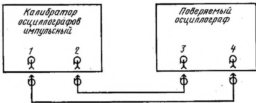
1 — выход калибратора временных интервалов; 2 — выход синхронизирующих импульсов; 3 — вход синхронизации; 4 — вход усилителя  $U$
