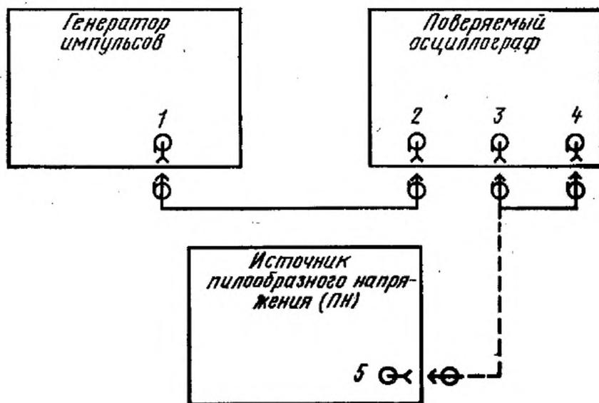
1 — выход основных импульсов; 2 — вход усилителя X; 3 — вход усилителя Y; 4 — выход напряжения развертки; 5 — выход пилообразного напряжения
