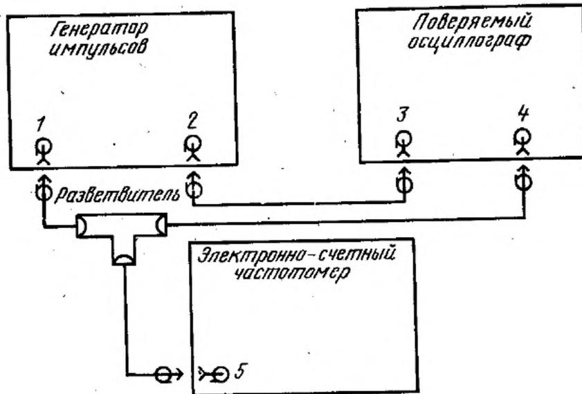
1 — выход основных импульсов; 2 — выход синхронизирующих импульсов; 3 — вход синхронизации; 4 — вход усилителя У; 5 — вход частотомера
