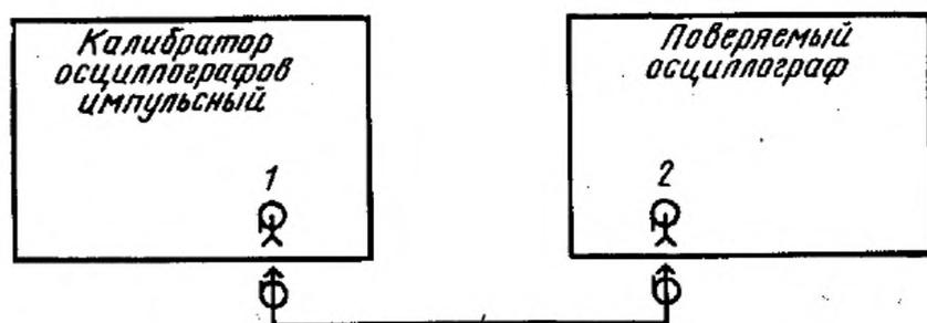
1 — выход калибратора напряжения; 2 — вход усилителя У.
