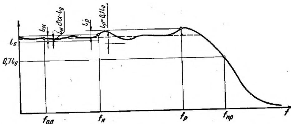
$f_{оп}$  — опорная частота;  $f_{н}$  — нормальный диапазон;  $f_{р}$  — расширенный диапазон;  $f_{пр}$  — верхняя граница полосы пропускания;  $l_0$  — значение АЧХ на опорной частоте;  $l_{н}$  — абсолютное значение неравномерности в нормальном диапазоне;  $l_{р}$  — абсолютное значение неравномерности в расширенном диапазоне;  $\delta_x$  — относительная погрешность коэффициента отклонения
