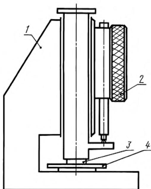
1 — корпус; 2 — индикатор часового типа; 3 — индентор; 4 — образец
