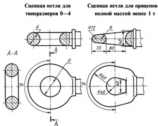
Присоединительные размеры сцепной петли для прицепов, технические задания на которые утверждены после 01.01.87, буксируемые тяговыми крюками типоразмеров 2 и 3
