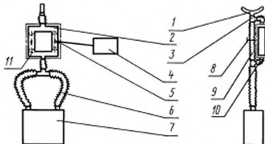
I вариант — в случае использования СИЗ ОД с маятниковой схемой дыхания; II вариант — в случае использования СИЗ ОД с круговой схемой дыхания; 1 — шлем или загубник; 2 — разделительное устройство; 3 — тройник; 4 — регистрирующий прибор; 5 — термометр сопротивления; 6 — дыхательные шланги СИЗ ОД, 7 — очистная система СИЗ ОД с дыхательным мешком; 8 — винтовой зажим; 9 — соединительная трубка; 10 — соединительная трубка; 11 — клапан разделительного устройства
