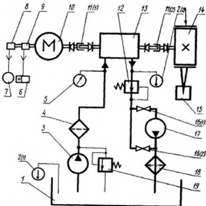
1—бак; 2—термометр; 3—насос подающий; 4—фильтр; 5—манометр;
