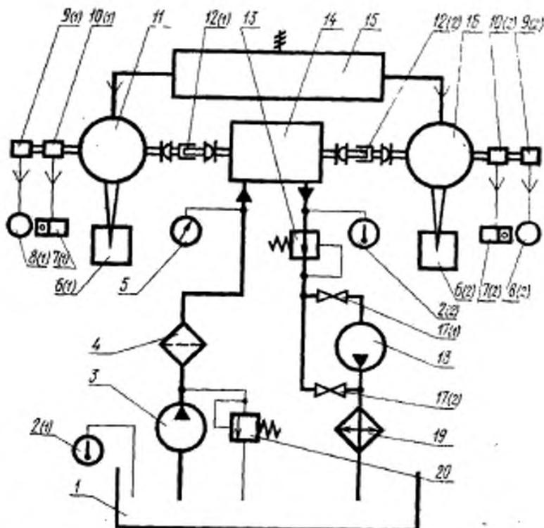
1—бак; 2—термометр; 3—насос; 4—фильтр; 5—манометр; 6—весы; 7—счетчик импульсов; 8—измеритель тахометра; 9—датчик тахометра; 10—датчик импульсов; 11—балансирующая машина; 12—шарнирно-телескопическое соединение валов; 13—редукционный клапан; 14—испытываемая гидротрансформация; 15—преобразователь постоянного тока; 16—нагрузочное устройство (балансирующая машина, тормоз индукторный или другого типа); 17—вентиль; 18—насос откачивающий; 19—теплообменник; 20—предохранительный клапан.
