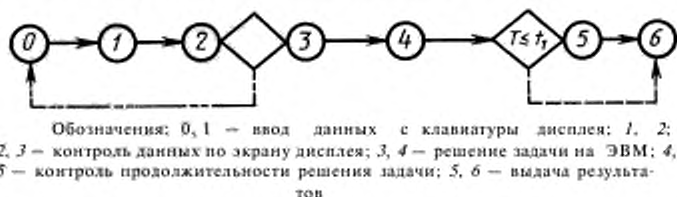
Рисунок 2 — Логико-сетевой граф, соответствующий обработке на ЭВМ оперативных данных с ограничением t_r времени T решения задачи
