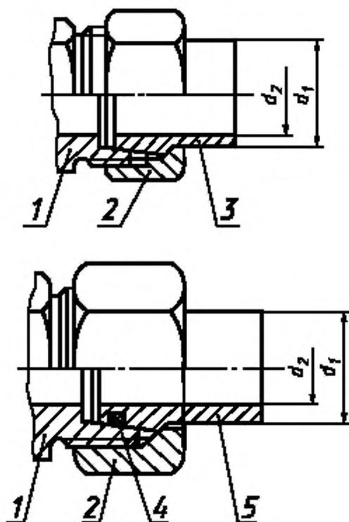
1 — конец корпусной детали с углом конуса  $24^\circ$  — по ГОСТ 22525; 2 — накидная гайка по ГОСТ 23353; 3 — конический ниппель исполнения 1; 4 — резиновое кольцо круглого сечения по ГОСТ 9833; 5 — конический ниппель исполнения 2
