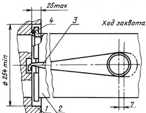
1 — бортовой штуцер; 2 — наконечник аэродромного кондиционера или подогревателя; 3 — захват; 4 — уплотнительное кольцо
