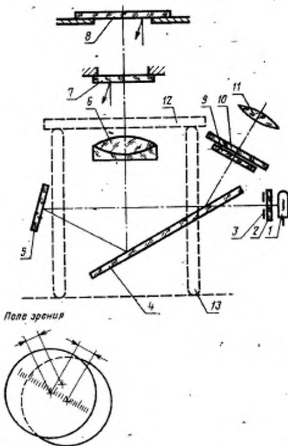
1—источник света; 2—молочное стекло; 3—маска; 4—полупрозрачное зеркало; 5—зеркало; 6—объектив; 7—светоделительное зеркало; 8—призматическое стекло; 9—матовый экран; 10—измерительная сетка; 11—вспомогательная лупа; 12—контрольное зеркало; 13—опорные стойки
