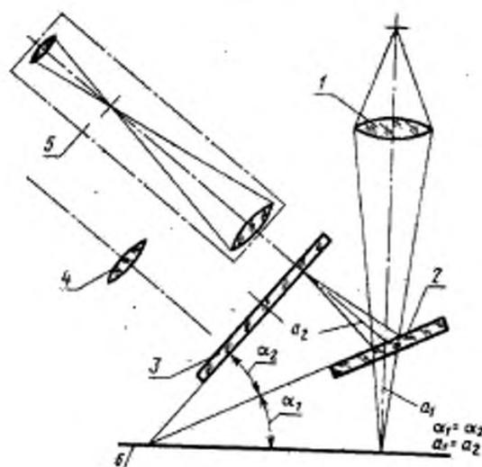
1—объектив фотоувеличителя; 2—зеркало; 3—матовый экран определителя резкости; 4—лупа; 5—микроскоп; 6—плоскость экрана-основания фотоувеличителя
