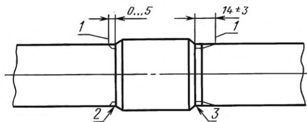
1 — конец сбega резьбы; 2 — соединение, свинченное на станке; 3 — соединение, свинченное вручную
