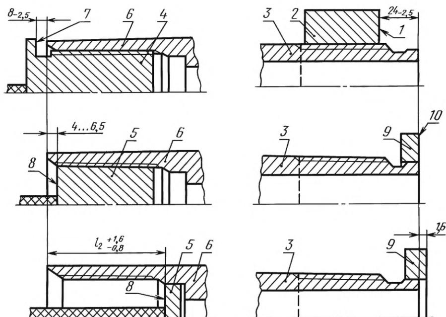
1 — измерительная плоскость резьбового и гладкого калибров-колец; 2 — резьбовой и гладкий калибры-кольца; 3 — труба ОТТГ и nippleный конец трубы ТБО; 4 — резьбовой калибр-пробка; 5 — гладкий калибр-пробка; 6 — муфта ОТТГ и раструбный конец трубы ТБО; 7 — измерительная плоскость резьбового калибра-пробки; 8 — измерительная плоскость гладкого калибра-пробки; 9 — гладкий калибр-кольцо; 10 — измерительная плоскость гладкого калибра-кольца
