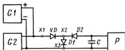
G1 — генератор прямого тока с выходным сопротивлением  $R_{\text{max}_1}$ ; G2 — генератор обратного напряжения с выходным сопротивлением  $R_{\text{max}_2}$ ; X1, X2, X3 — выводы;
