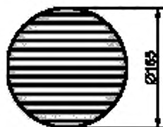
Рисунок 2 — Ударный элемент, моделирующий голову
