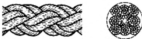
Рисунок 3 — Конфигурация 8-рядного плетеного каната (тип L)
