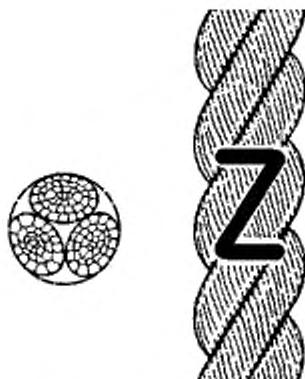
Рисунок 1 — Конфигурация 3-рядного крученого каната (тип А)
