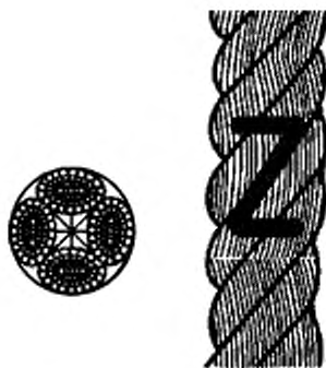
Рисунок 2 — Конфигурация 4-рядного крученного каната (тип В)
