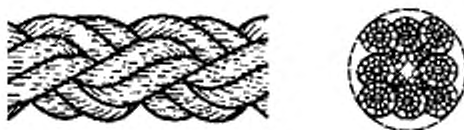
Рисунок 3 — Конфигурация 8-рядного плетеного каната (тип L)
