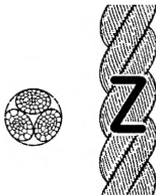
Рисунок 1 — Конфигурация 3-рядного крученного каната (тип А)
