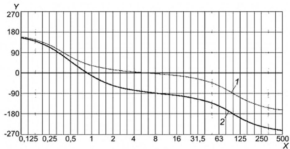
Рисунок В.8 — Фаза функции частотной коррекции W_e
