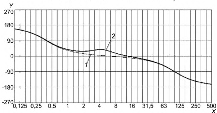
Рисунок В.13 — Модуль функции частотной коррекции W_j
